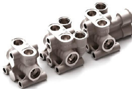
HDF-AMES er 3D-printede stakbare retningsventiler. Kroppen er fremstillet i rustfrit stål 316L med LPBF-teknologi, som binder metallisk pulver sammen med en avanceret laser.
